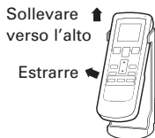
③ Estrazione del telecomando (per uso da altre posizioni).
