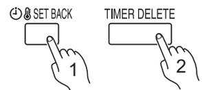
Appuyez sur le bouton SET BACK (RÉTABLIR), puis sur le bouton TIMER DELETE (SUPPRESSION DE LA MINUTERIE) lorsque la confirmation SET BACK (RÉTABLIR) est affichée. Même si le bouton SET BACK (RÉTABLIR) est à nouveau pressé, la minuterie RÉTABLIR sera annulée.
