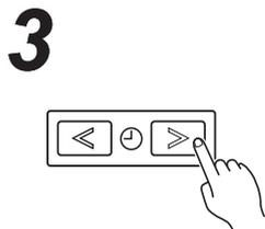
Appuyez sur les boutons SET TIME (RÉGLER L'HEURE) (< >) pour régler l'heure actuelle. Pressez de façon répétée pour régler l'heure courante par incrément de 1 minute. Pressez et maintenez enfoncé pour régler l'heure courante par incrément de 10 minutes.
