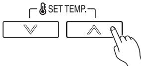
Appuyez sur les boutons SET TEMP (RÉGLER LA TEMPÉRATURE) pour régler la température. (La plage de configuration de la température est identique à celle du mode de fonctionnement.)
