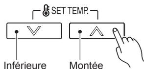
Appuyez sur les boutons SET TEMP (RÉGLER LA TEMPÉRATURE) pour régler la température de la pièce.
