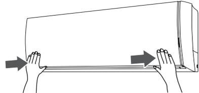
Si la rejilla de entrada no está completamente cerrada, el acondicionador de aire no funcionará y el indicador parpadeará, tal y como se muestra a continuación.
