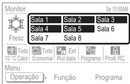
As unidades interiores ligadas (Sala X) são apresentadas. A unidade interior em funcionamento é realçada. Para a definição de funcionamento/paragem das unidades interiores, consulte [6. DEFINIÇÃO DE FUNCIONAMENTO].
